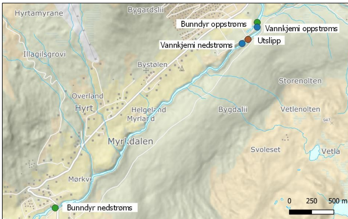
Figur 3. Plassering av utslipp (rødt punkt), samt prøvetakingspunktene for vannkjemi (blå punkt) og bunndyr (grønne punkt) opp- og nedstrøms utslippet i Myrkdalselven.
