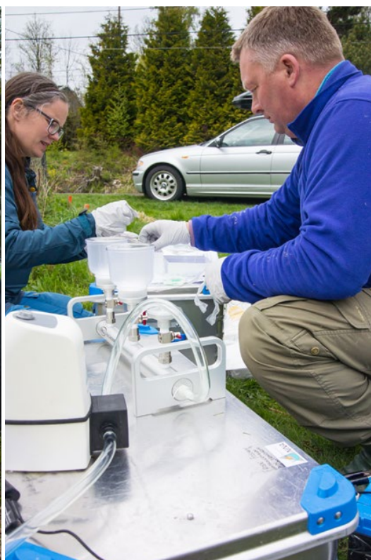
Bilde 4.3 og 4.4. To ulike filtreringsmetoder for innsamling av Miljø-DNA prøver. Bilde til venstre viser en teleskopstang påmontert ei peristaltpumpe med filterholder. Med denne metoden filtreres vannet samtidig med innsamling. Bilde til høyre viser filtrering av vann med manifoil påsatt filter. Ved bruk av denne metoden må vann til filtrering samles inn i ei kanne for filtrering i etterkant.
