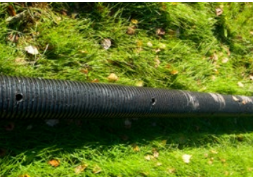
Bilde 9.14. Det er boret hull med et 16 mm bor for hver 30 cm både over og under dreneringsrørene.
