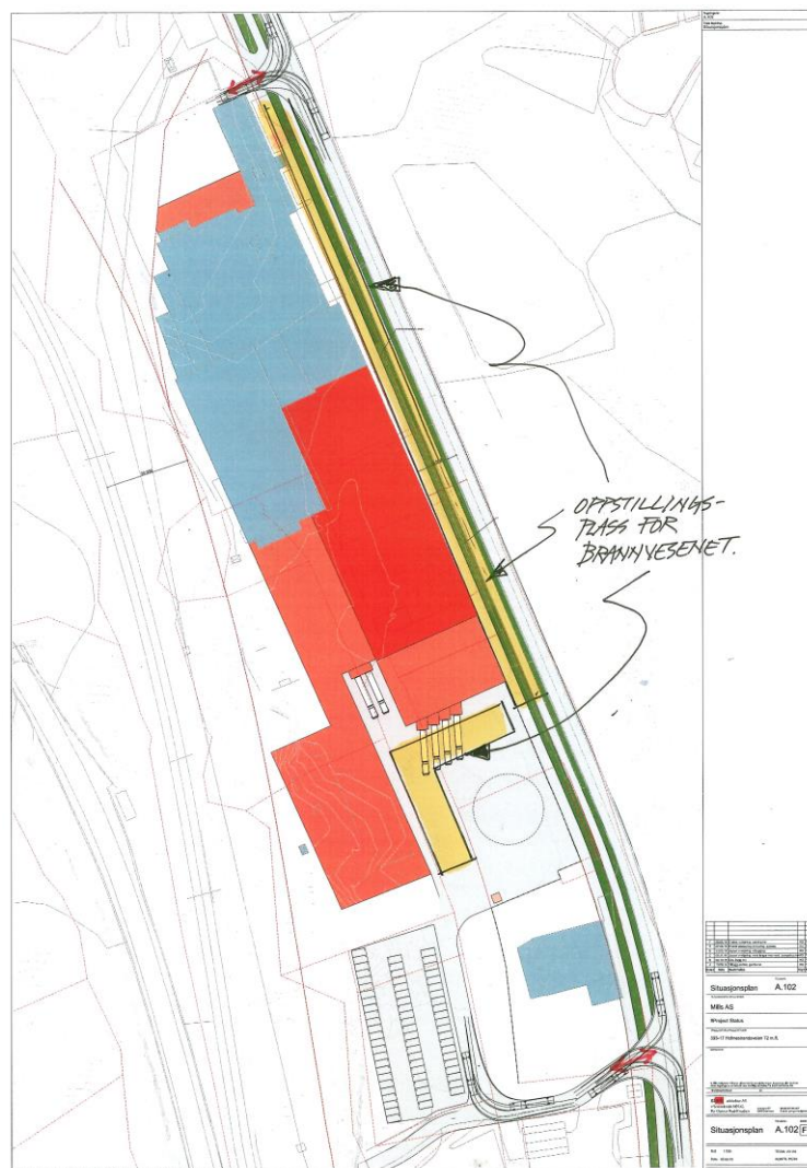
Figur 22, illustrasjon av oppstillingsplass for brannbiler
