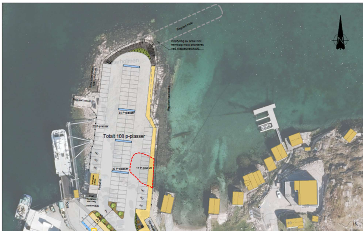
Figur 2 Detaljtegning av planlagt fergeleie ved Dyrøy. Areal i sjø som berøres av fylling er markert med rød stiple linje.
