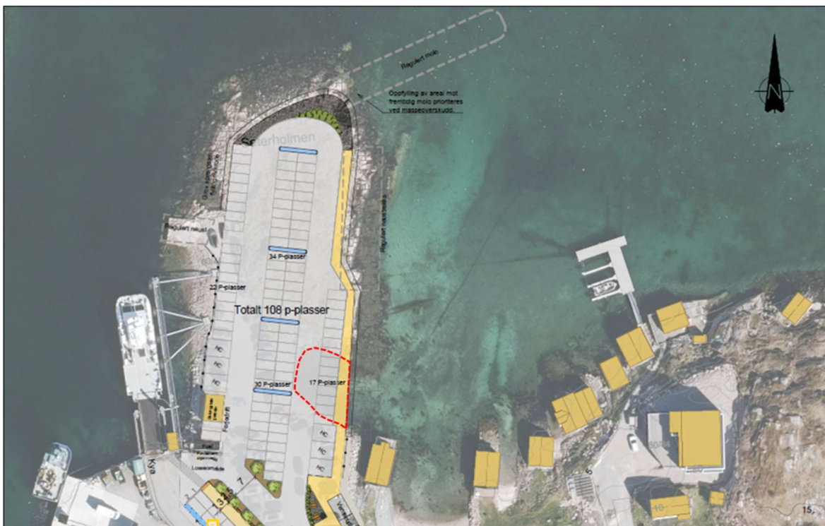
Figur 1 Detaljtegning av planlagt utbygging ved Dyrøy fergeleie. Fylling i sjø er markert med rød linje.
