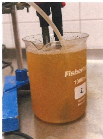
Figur 1. Luftning med måtning av Redox og pH.
