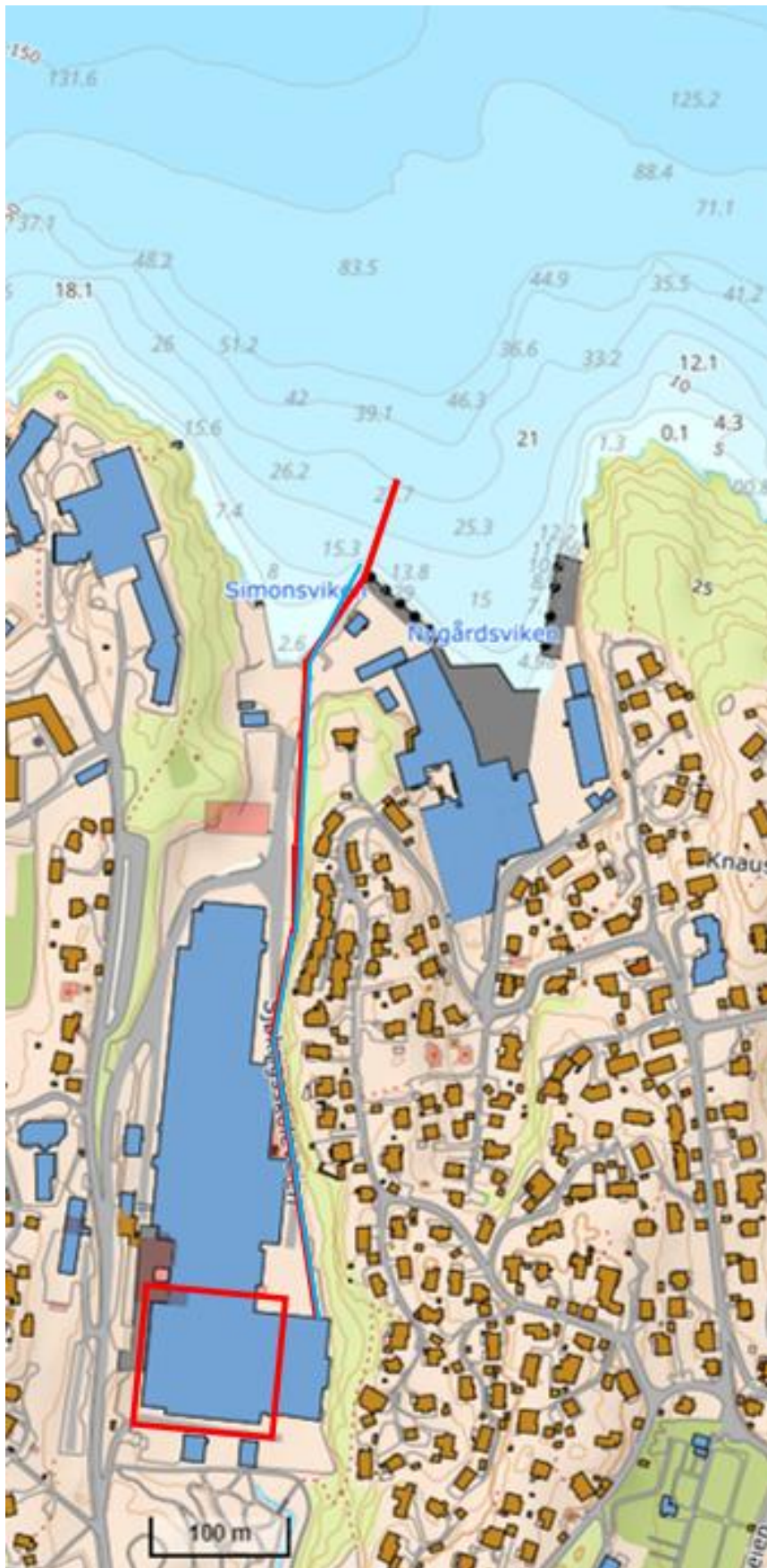
Figur 3: Planlagt trase for ledninger til inntak/utslipp av sjøvann til omvendt osmose-anlegg. Rød linje viser plassering av inntaksledning mens blå linje viser utslippsledning. Det røde rektangelet viser plassering av vaskeanlegget.
