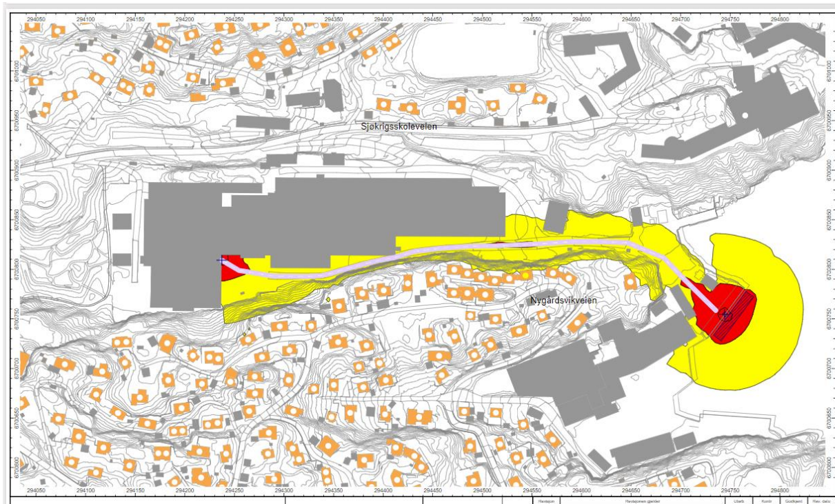
Figur 10: Støysonekart ved lasting av båt, område markert med gult > 55dB, markert med rødt >65 dB (Sweco, 2017).
