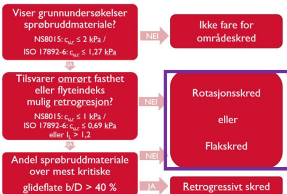
Figur 4.3 Flytskjema for vurdering av aktuell skredmekanisme
