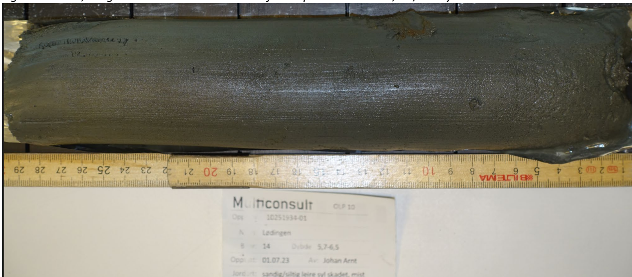
Figur 4-5: Leire, siltig fra borpunkt SW14 ved 5,7-6,5 m dybde, skadet sylinder. Denne leiren er klassifisert som leire med sprøbruddegenskaper.
