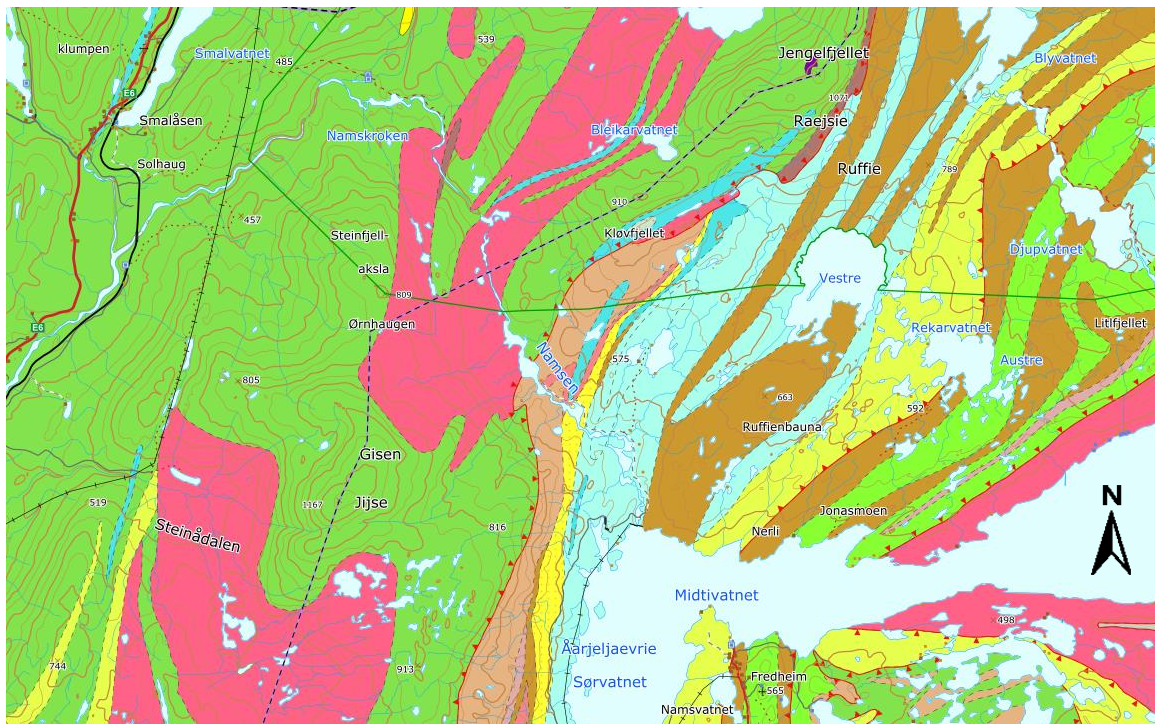
Figur 5-1: Kartet viser berggrunnen i Namsvassområdet og nedstrøms dammen (nord for Namsvatnet). Kalkfylitt er angitt med lyseblå farge. Konglomerat med fragmenter av karbonat (gult), grønnstein (brunt), båndet amfibolitt og metagabbro (lysebrun), og granitt og glimmerskifer (henholdsvis rosa og grønt) finnes også i området. Kilde: NGUs berggrunnskart [17].
