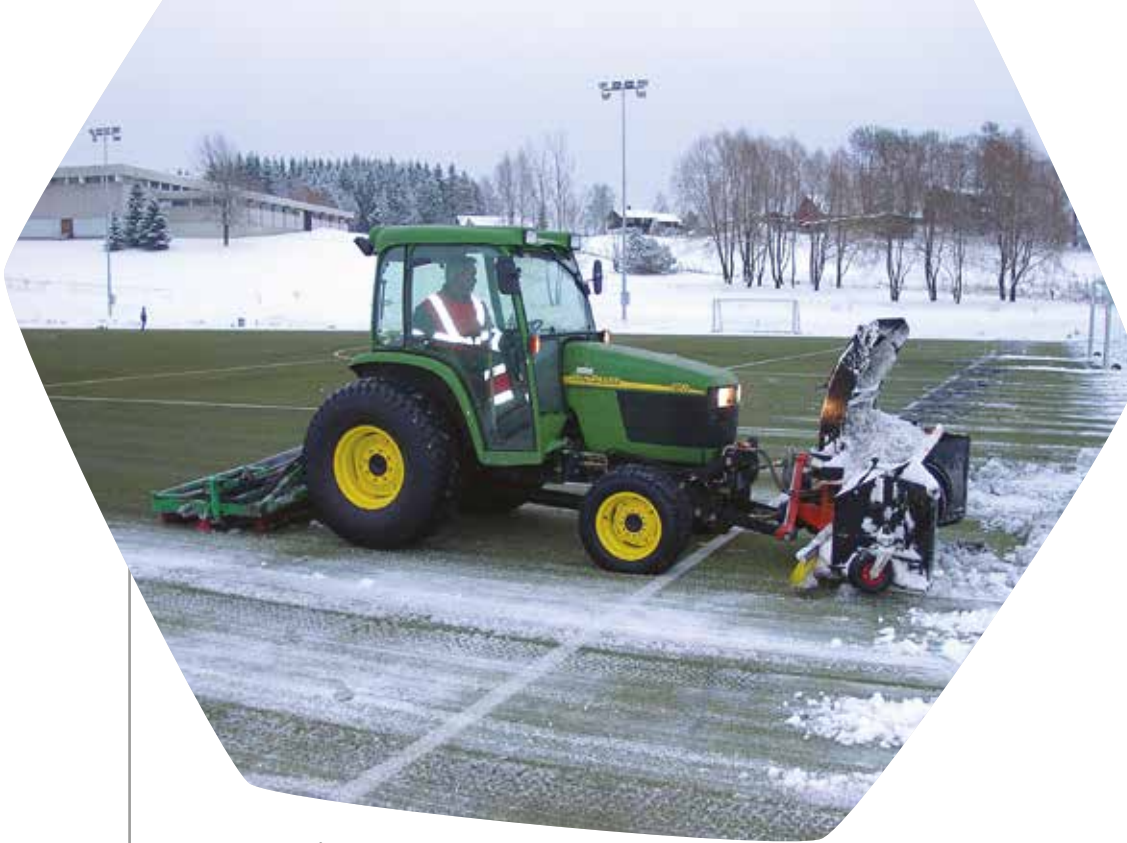
Frontmontert snøfres og bakmontert hydraulisk slådd.
