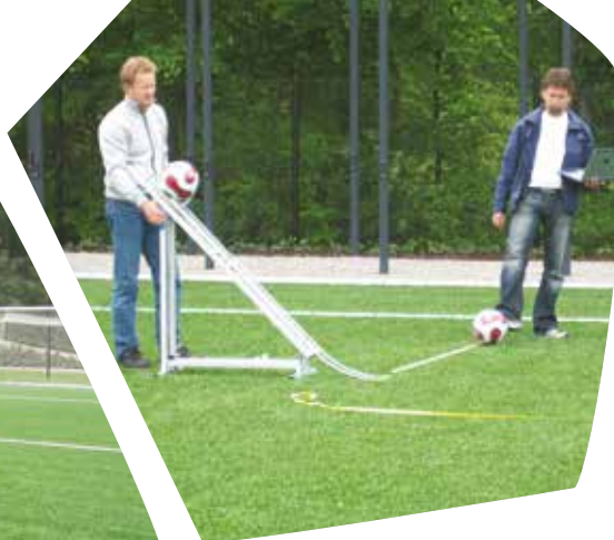
Test av ballrulle
