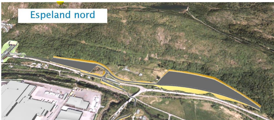
Figur 10. Arealer på Espeland til rigg, knuseverk og anleggsvei til tunnelpåhugg nord i området.
