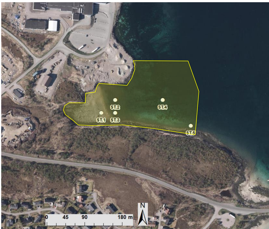
Figur 4: Børøya industriområde, utfylling sørøst. Flyfoto med markering av prøvestasjoner og omtrentlig område for planlagt utfylling i sjø. Kartkilde: www.finn.no .
