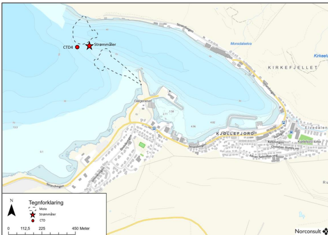
Figur 1: Oversiktskart over planlagt molotiltak. Målestasjonene for gjennomføring av hydrografiske målinger av vannmassene er markert med en rød prikk. Plasseringen av strømmåler er markert med rød stjerne.
