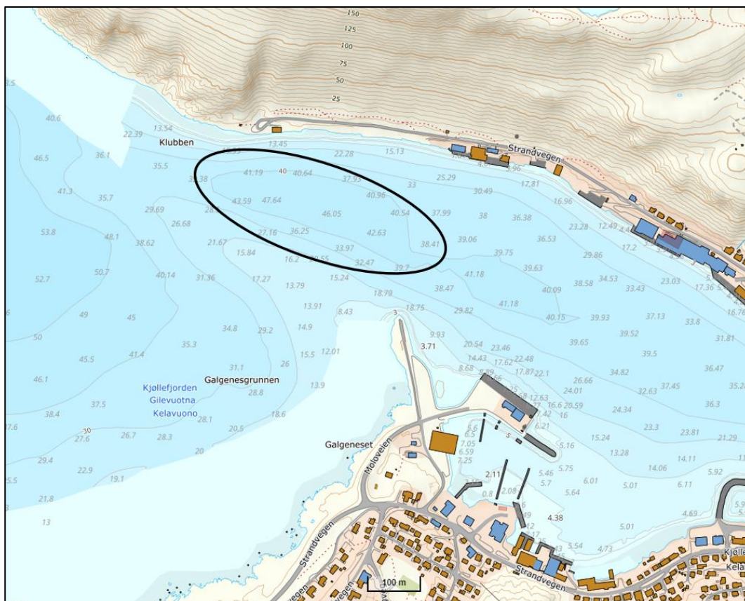
Figur 1: Oversiktskart som viser område som undersøkes som potensielt sjøbunnsdeponi i Kjøllefjord. Undersøkelsesområdet er vist som sort sirkel. Figuren er hentet fra undersøkelsesprogrammet utarbeidet av Norconsult.
