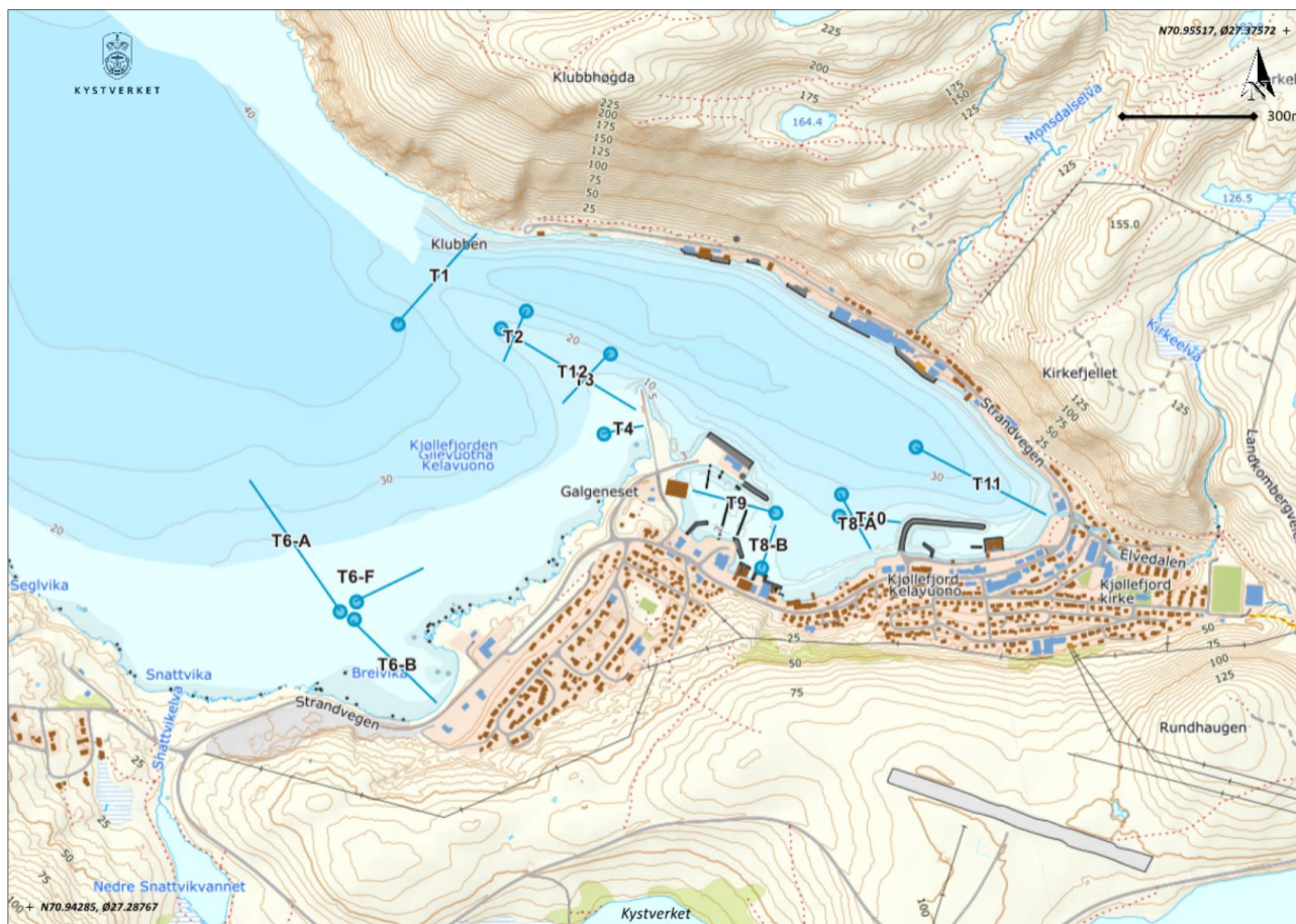
Figur 2-1: Det er kjørt 12 videotransekter. Disse er fordelt på tre inndelte områder: ett for indre havn (T8, T9, T10 og T11), ett for ytre havn nord (T1, T2, T3, T4 T12), og ett for ytre havn sør (T6-A, T6-B og T6-F). Sirkel indikerer start på filming av transektet.
