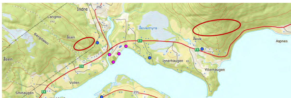
Figur 3 Grunnvannsbrønner. Blå punkter markerer grunnvannsbrønner boret til fjell, og rosa punkter markerer sonderboringer.
