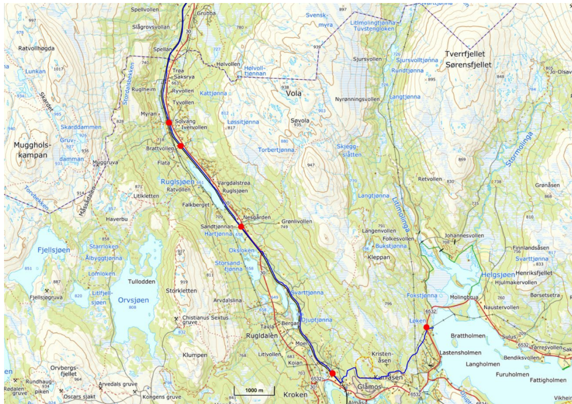
Kart 2: Sperregjerde mot jernbanen, strekning Rugldalen-Glåmos (stedsnr. 2 i oversiktskartet). Sperregjerdet er tegnet med blå strek. Krysningspunkter der reinen kommer gjennom gjerdet er markert med røde sirkler.
