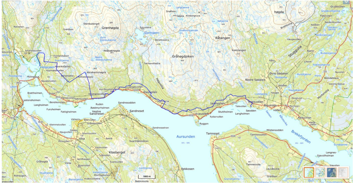
Kart 3: Aursundgjerdet, markert med blå strek (stedsnr. 3 i oversiktskartet) fungerer dårlig til å stoppe rein. Utfordringer: Altfor mange porter, grunder og ferister (opp mot 90 passeringspunkter totalt). Spesielt vestre del av gjerdet, som er satt opp delvis i fjellet og i skogen, ligger langt unna annen infrastruktur, slik at det er vanskelig å holde tilsyn. Feristene fungerer også dårlig, også de elektriske.
