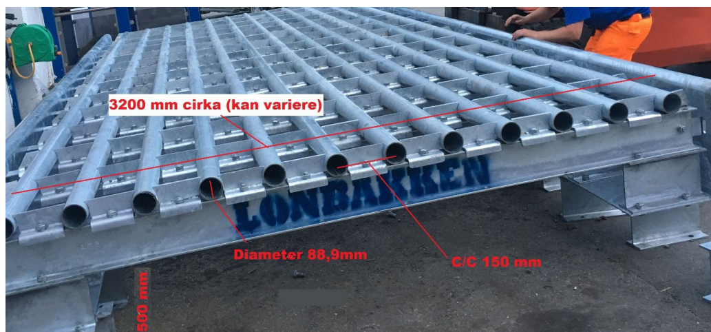
Bilde 16: Ferist fra Lonbakken AS, med nøkkelmål. Erfaringene er at denne typen ferist stopper rein (foto: Lonbakken).
