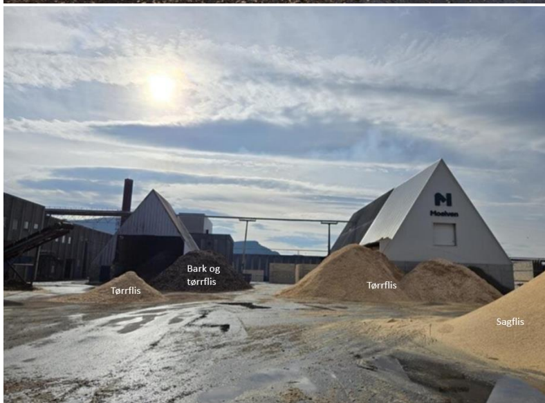
Figur 6. Lagring av flis sett fra ulike synsvinkler. Bilde øverst viser ulike typer flis som bli lagret. Bildet nederst viser de samme lagerhaugene sammen med noen av siloene (lagerbingene) for lagring av flis under tak. Industriflis lagres i bingje på lagertomta for tømmer.
