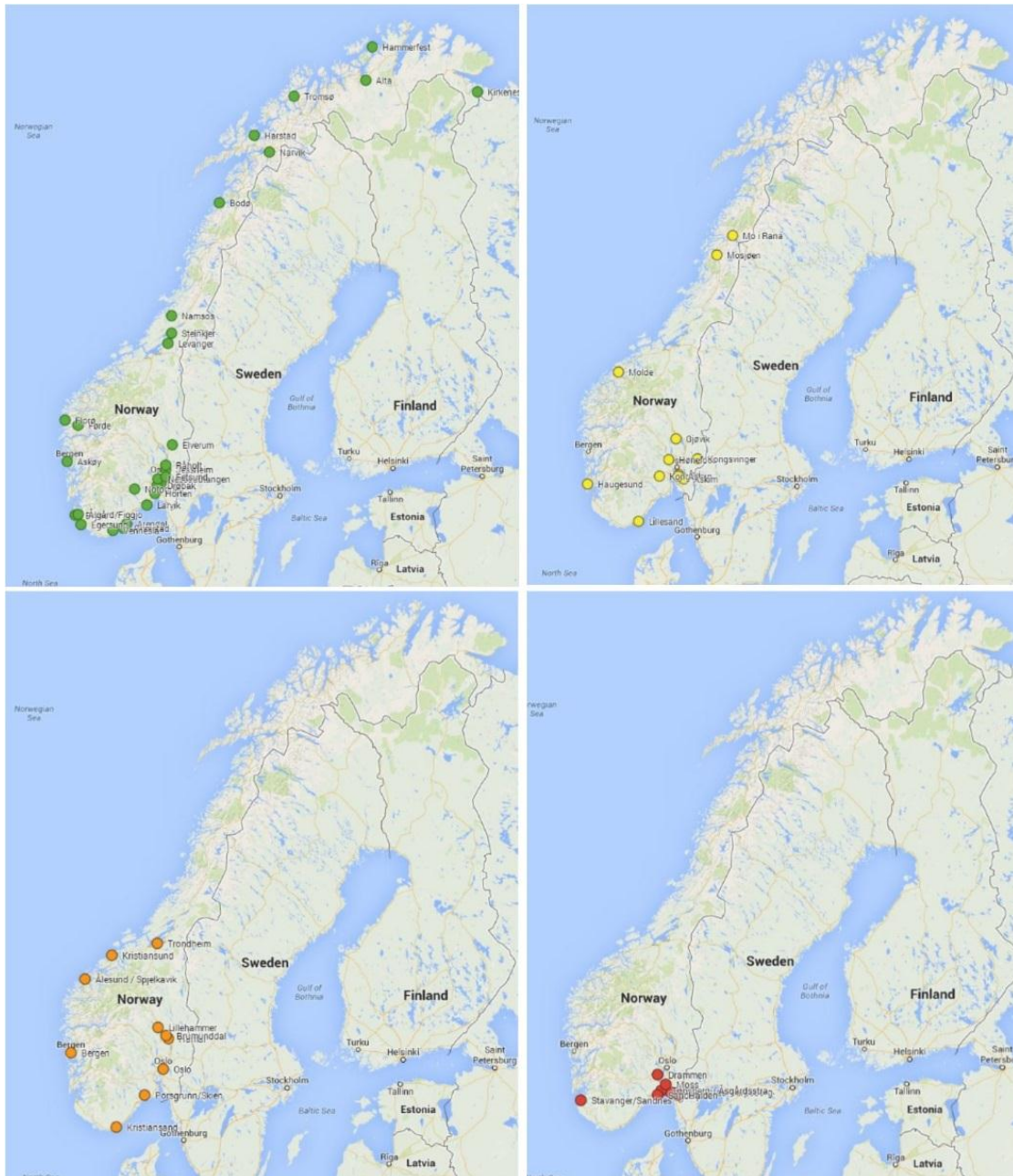
Figur 21: PM 10 -Grovkartlegging av dagens luftforurensningssituasjon i norske byer og tettsteder basert på målt og beregnet døgnmiddelverdi. Grønn: årsmiddelverdier er under den nedre vurderingsterskelen; Gul: årsmiddelverdier er mellom de nedre og øvre vurderingsterskelene; Oransje: årsmiddelverdier er mellom øvre vurderingsterskelen og grenseverdien. Rød: årsmiddelverdier er over grenseverdien.
