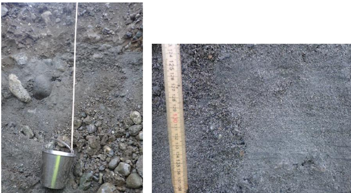
Figur 7: Eksempel frå sjaktene C4 (venstre) og C3 (høgre) på dei grovkorna og permeable massane som dominerer i tiltaksområdet.
