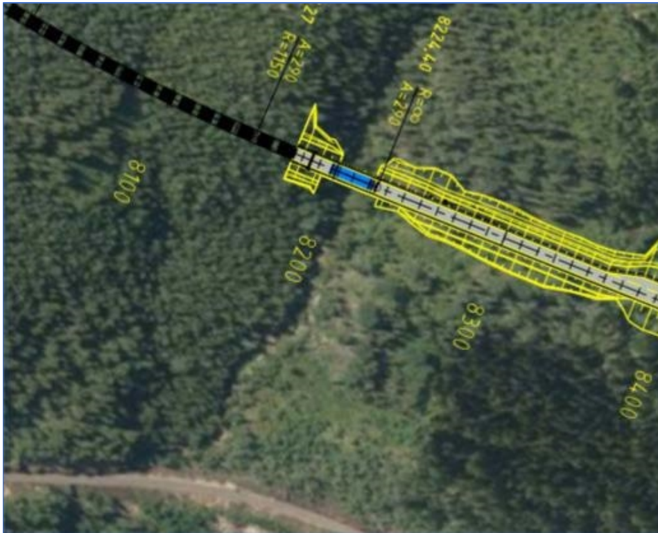
Fig 5 Påhogg nord. Kun påhogg og portal her. Tunnelen drives fra motsatt side.
