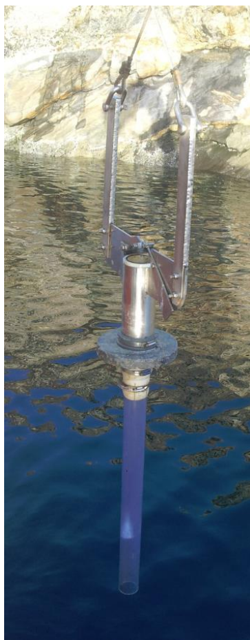
Figur 5: Bildet til venstre viser en Abdullah corer som ble benyttet under prøvetaking av sedimenter for vurdering av forurensningsmektighet i Bodø havn. Bildet til høyre viser en 20 l Van Veengrabb som ble benyttet til prøvetaking av overflatesedimenter til porevannsanalyser i havna og til tilstandsvurdering av sedimentene i deponiområdet i Nyholmsundet.
