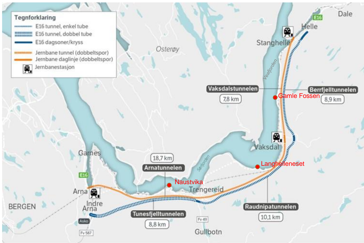
Figur 2-1. Jernbane- og vegtraseen frå Arna til Stanghelle som er vedtatt i reguleringsplanen. Illustrasjon: SVV. Lokalisering av bergsjakter for deponering av steinmassar er vist med raud sirkel (Naustvika, Langhelleneset og Gamle Fossen).
