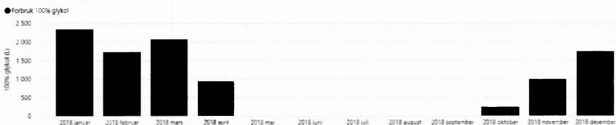
Figur 3. Forbruk av flyavisingkjemikalier i 2018 sammenlignet med årlig, tillatt mengde.
