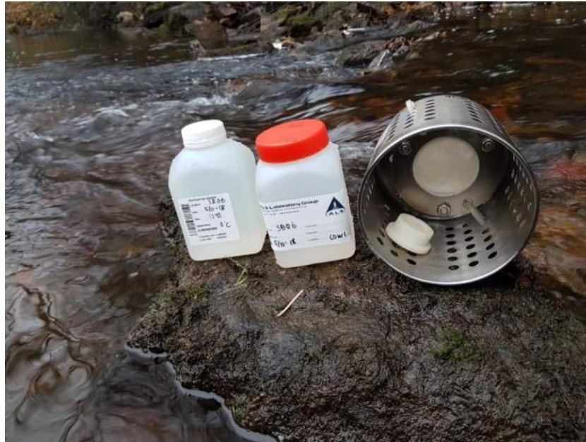
Figur 13: Viser flasker som ble benyttet, samt de passive prøvetakere (DGT og POCIS) som ble hentet fra Straisbekken i november 2018.
