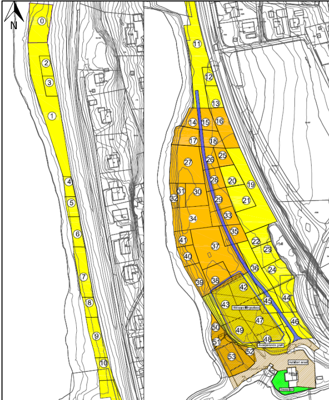
Figur 2-6 Skisse som viser områder på land som er sanert i perioden 2011-2015. Området er delt inn i 53 delområder. Delområdene er merket med farge etter høyeste gjenbrukte tilstandsklasse av sumPAH 16 iht. TA-2553. Utsnitt av Multiconsult-tegning 415257-RIGm-TEG-001 rev.A.
