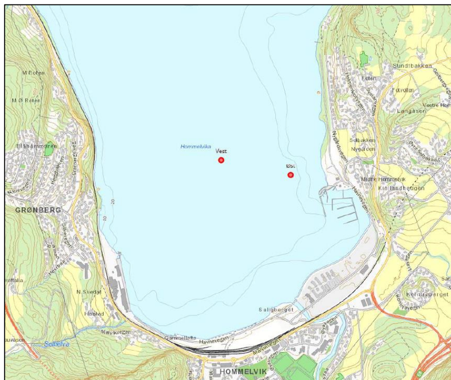
Figur 5-6 Plassering av strøm- og turbiditetmålere i Hommelvikbukta, 6.-20.12.2017.
