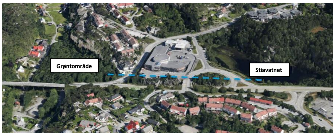
Figur 8: Illustrasjonsskisse som viser ca. lokalisering av ny kulvert for utløp fra Stiavatnet med blå stiplet linje (figur 14 i Fagrapport FR 15, Rammeplan VA Bergen (Rambøll, 2016b). Kulverten vises også i utsnitt fra gjeldende reguleringsplan i Figur 9.
