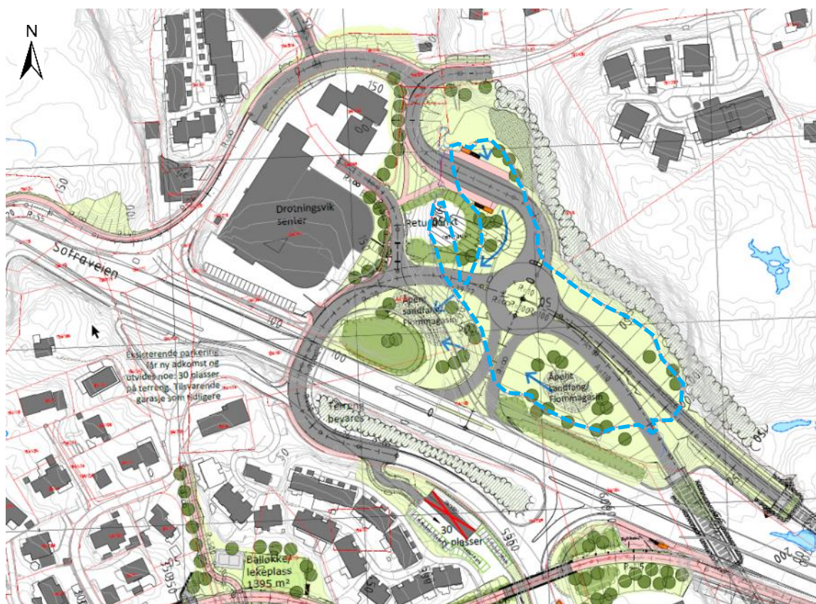
Figur 6: Utsnitt av landskapsplan for Drotningstovik som viser etablering av rundkjøring og påkjøringsramper for ny Rv. 555 på dagens Stiavatnet (Kilde: planbeskrivelsen, utsnitt fra tegning O-11). Omrisset av Stiavatnet er markert med blå, stiplet linje. Blå piler viser flomveier. Prosjektering pågår, mindre endringer vil forekomme.
