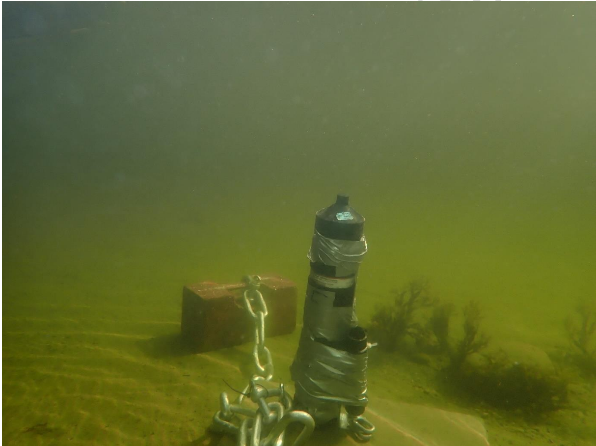
Lyttestasjon og datalogger for temperatur og salinitet (liten svart sylinder) plassert på bløtbunnsområdet ved Ørin. Foto: Jan Grimsrud Davidsen
