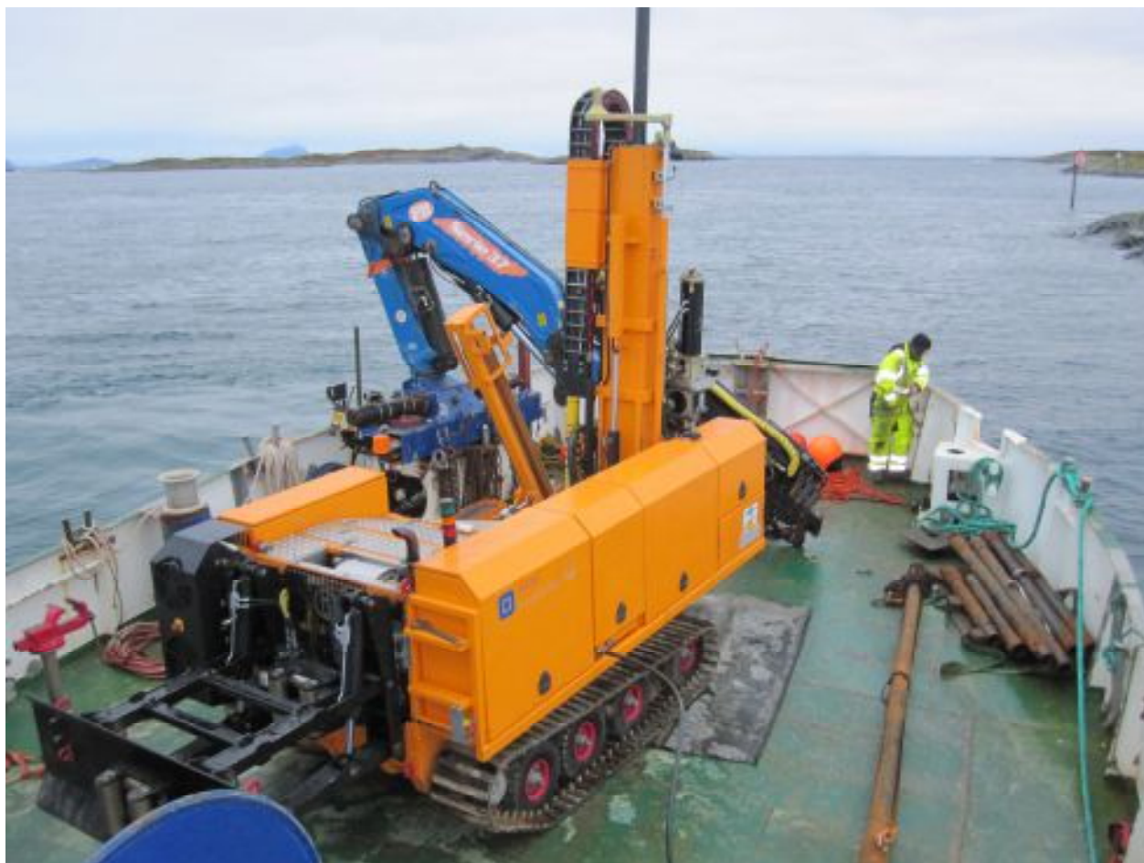
Figur 2 Geoteknisk borerigg Geotech 607.
