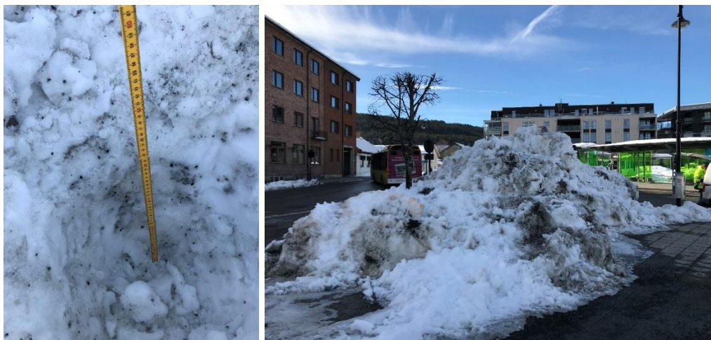
Figur 7. Bilde av snøprøvesjakt fra delprøve KongSnø 4-2 fra snøhaug på Kongsberg knutepunkt (venstre) og bilde av den aktuelle snøhaugen på Kongsberg knutepunkt.
