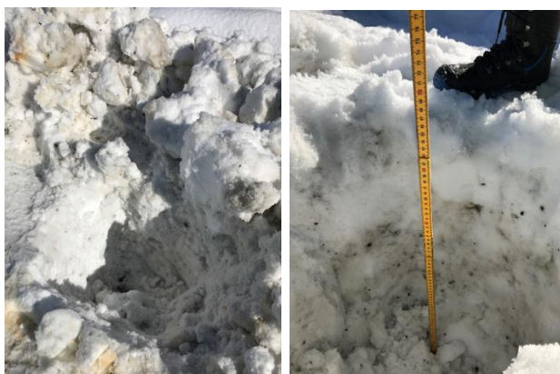
Figur 4. Bilde av snøprøvesjakt fra delprøve KongSnø 1-1 (venstre) og KongSnø 1-2 (høyre) på Kongsberg Teknologipark.
