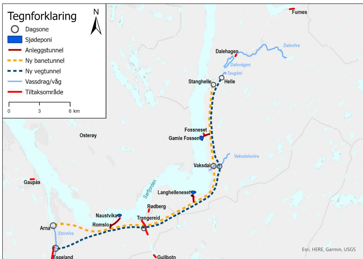
Figur 1: Reguleringsplan for Fellesprosjektet Arna-Stanghelle. Områdene som er aktuelle deponi- og riggområder med knuseverk, er markert i hvit sirkel.
