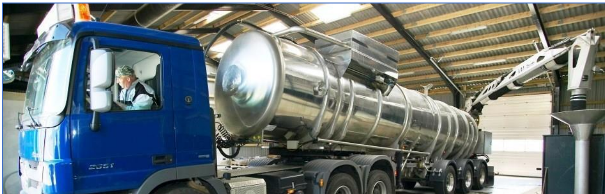
Bilde 6 Mottak av substrat vil foregå innendørs og med avtrekk og ventilasjon som renses før utslipp.
