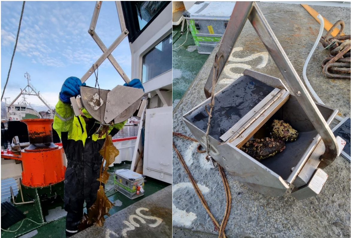
Figur 3. Van Veen grabb benyttet til prøvetaking i fergebåsen på Ørnes den 20. februar 2021.
