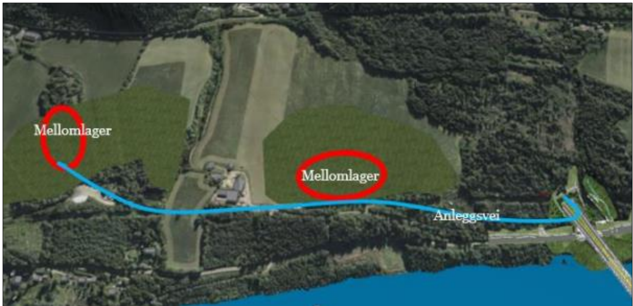
Figur 34. Illustrasjon som viser anleggsvei og planlagte mellomlagre ved Trosset rett ved utgang av tunnel før planlagt E6 går ut i bru over Lågen.
