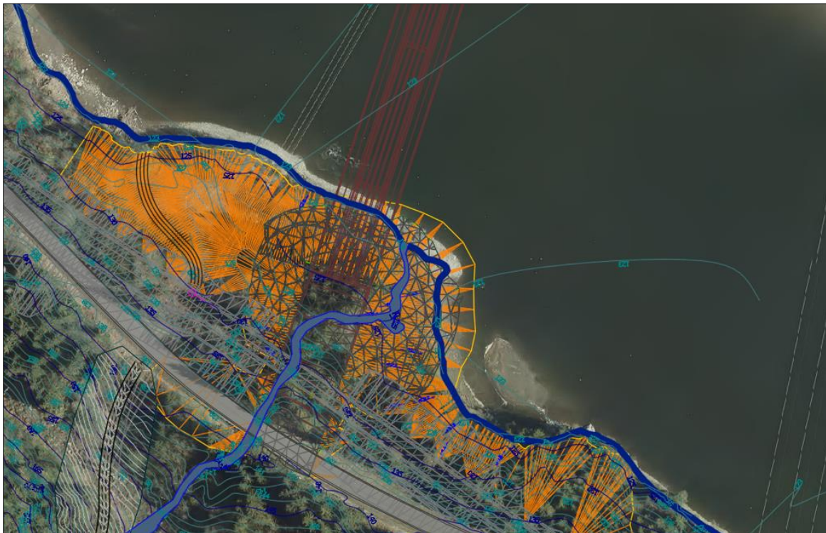
Figur 30. Utfylling på vestsiden av Lågen ved utgangen av brua. Den blå linjen viser vannkanten. Det er kun en liten del av fyllingen som vil være ute i Lågen vist med det gule område utenfor den blå linjen.
