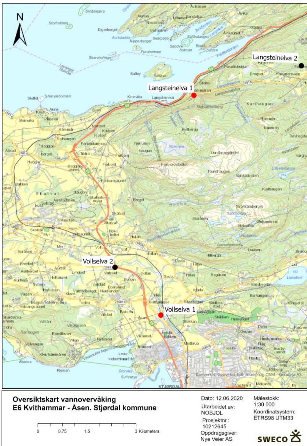
Figur 6 Prøvestasjoner for vannprøver E6 Kvithammar-Åsen. De røde punktene har automatiske loggere for pH og turbiditet i tillegg til vannprøvetaking.
