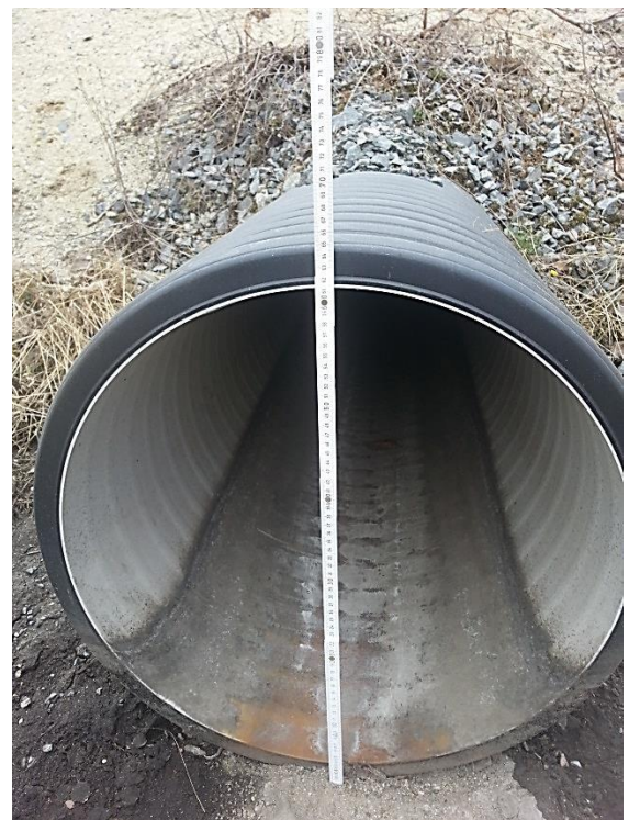
Figur 1. Dreneringsgrøft til målepunkt uten og med avrenning øverst. Rør hvor det ble montert måleutstyr (høydemåler med trykksensor) nederst. Rørets fall, vannhøyde og profil bestemmer vannmengden basert på en vannføringsformel for strømning i rør.
