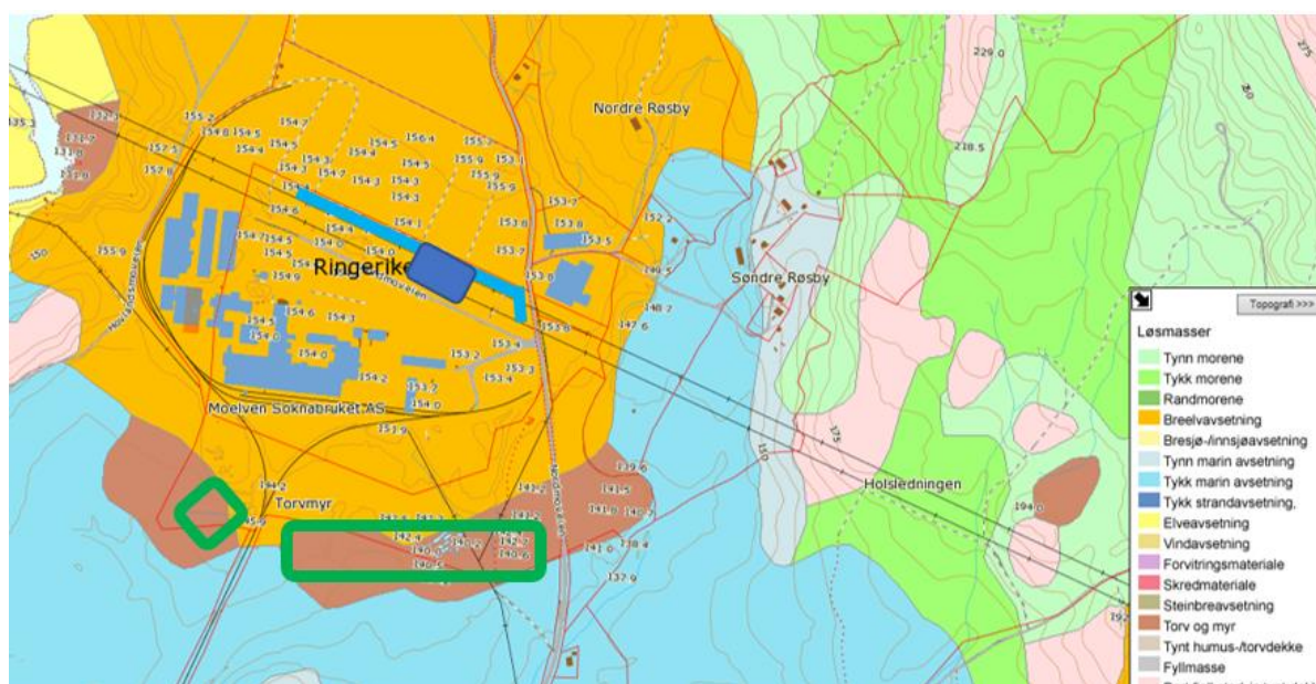
Figur 1. Kvartærgeologisk kart som viser jordtyper og områder markert for rensing. Oppsamlingskanal og infiltrasjonsbassenger i blått, dammer og våtmarksfilter i grønt.
