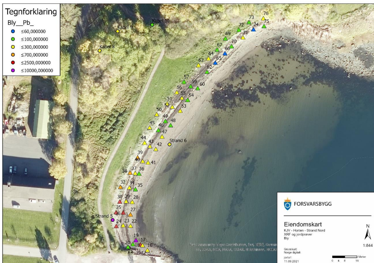
Figur 4.2: Flyfoto over lokalitet «strand nord» der det er vist punkter for XRF-målinger av sanden (0-0,1 m dyp) (vist med trekkanter). Fargene viser tilstandsklasser for bly. Figuren er tilsendt av Forsvarsbygg. Prøvepunktene markert med sirkler opppe til venstre i figuren er noen andre prøver Forsvarsbygg har tatt, som ikke er relevante for denne undersøkelsen.
