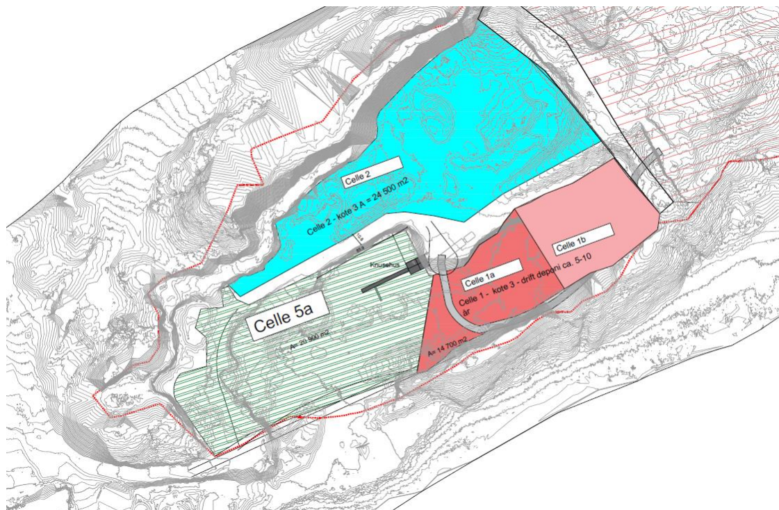
Figur 7 Celle 1, 2 og 5a vil utgjøre bunnen av deponiet på kote +3. Bergfestet mellom celle 1 og 2 vist som hvitt felt. Celle 1 kan deles og 1b da vil utgjøre separat celle for PFAS-masser
