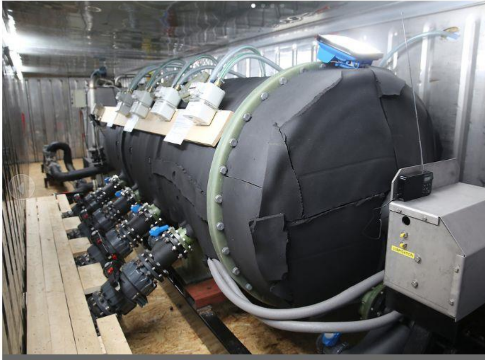
Antec Biogas sitt nye anlegg på Ås er inndelt i kamre, med stor biofilmovertflate som fremskynder bakterieveksten og reduserer omløpstiden for avfallet. (Bilde: øyvind.lie)
