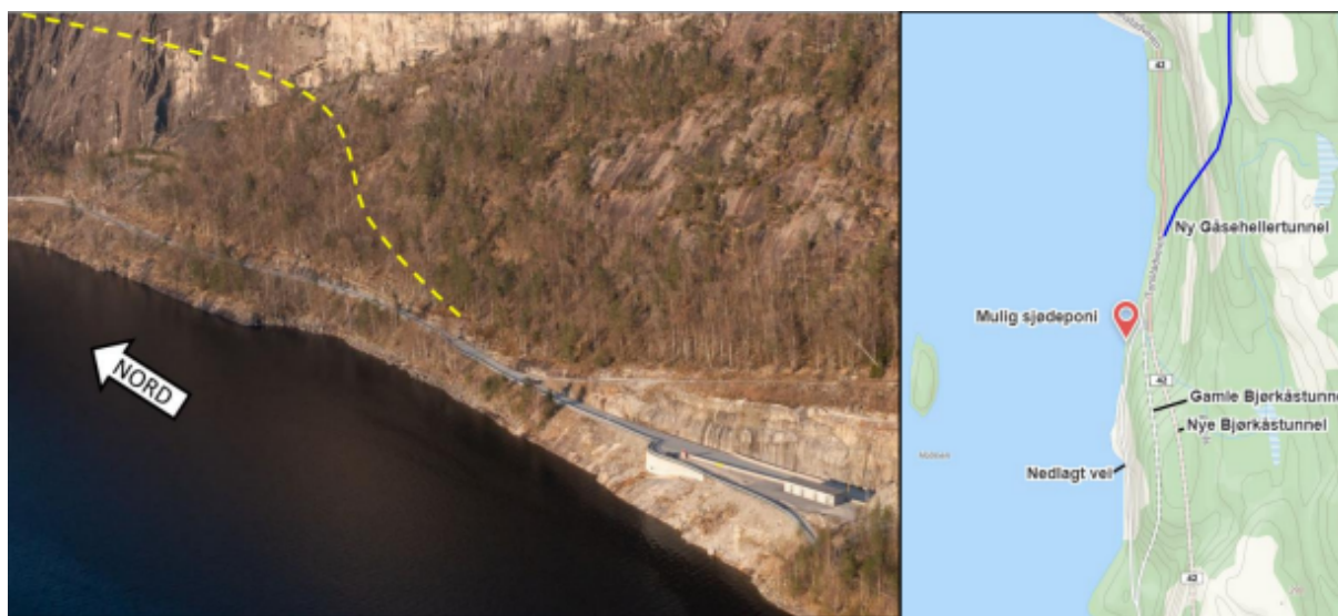
Figur 1 - Nordenden av Bjørkåstunnelen med stipling som markerer omtrentlig trasé for ny Gåseheller tunnel. Tipping av stein ut i Sirdalsvannet kan være aktuelt langs vannkanten vi ser på bildet. Foto 14.09.23 Agder FK. [Agder fylkeskommune, 2023].
