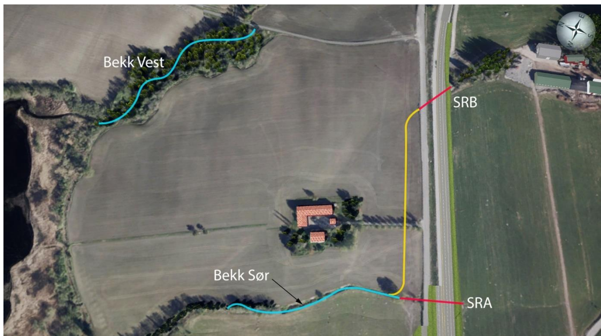
Figur 33: Eksisterende overvannshåndtering. Stikkrenne A (SRA) tilhører nedbørsfeltet fra Granåsbekken. Stikkrenne B (SRB) tilhører nedbørsfeltet fra Skjelstadbekken.
