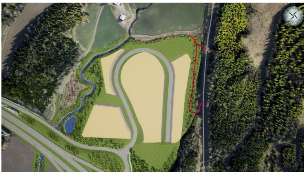
Figur 29: Åpen grøft mot Dulumbekken. Rød linje angir åpne vannveger fra stikkrenner tilknyttet Nordlandsbanen.
