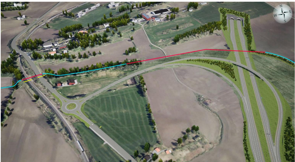
Figur 24: Planlagt vannveg og flomveg for Taura. Lyseblå linje viser åpen vannveg. Rød linje viser planlagt lukket rør. Gule linjer viser eksisterende stikkrenner under dagens E6 og Nordlandsbanen.
