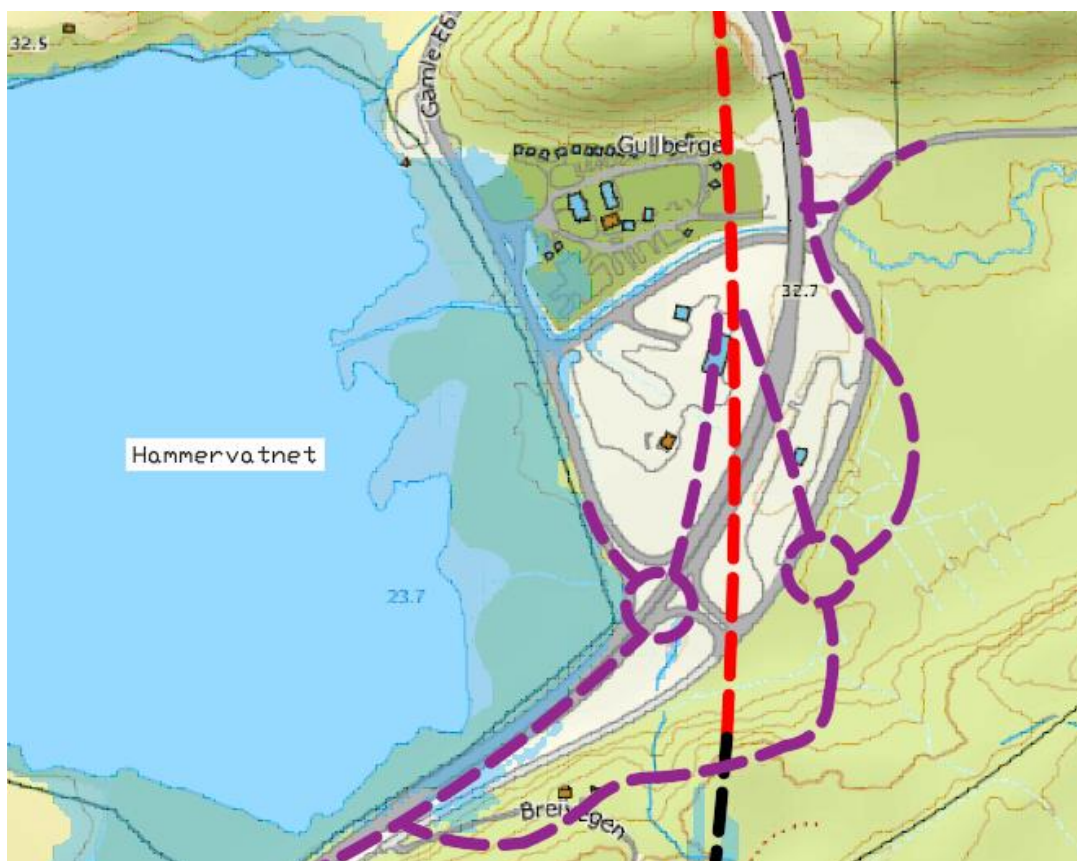
Figur 35: Vannstand ved 200-årsflom. Skravert lyseblått område viser vannivåstigning ved kote 25,78 moh. Stiplede linjer viser planlagte vegtraseer.
