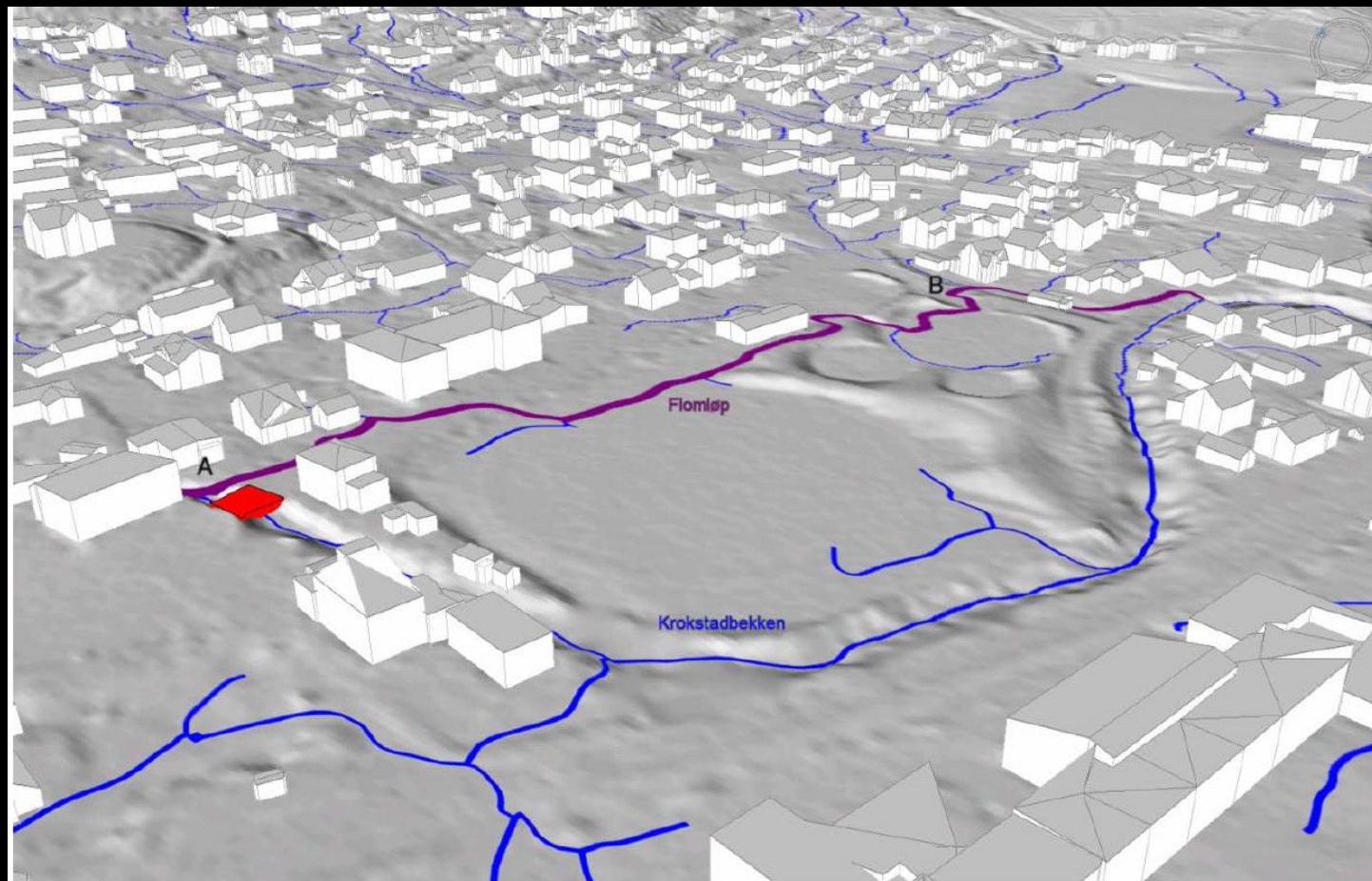
Figur 6: Terrengmodellen er endret ved A for å simulere effekten av en tett kulvert (rød flate). Flomvannet vil ta helt ny retning (lilla farge) mot B før det bøyer av mot det opprinnelige elveløpet. Flomveiene er moderat glattet.
