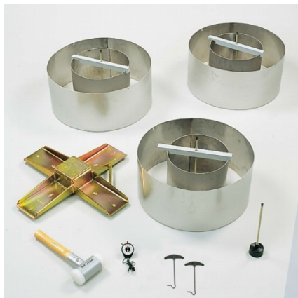
Figur 4. Settet som benyttes i ringtesten består av tre par av indre og yre ringer, en bankeplate, hammer, målebro og målepinne med dupp. ©Eijkelkamp Soil & Water
