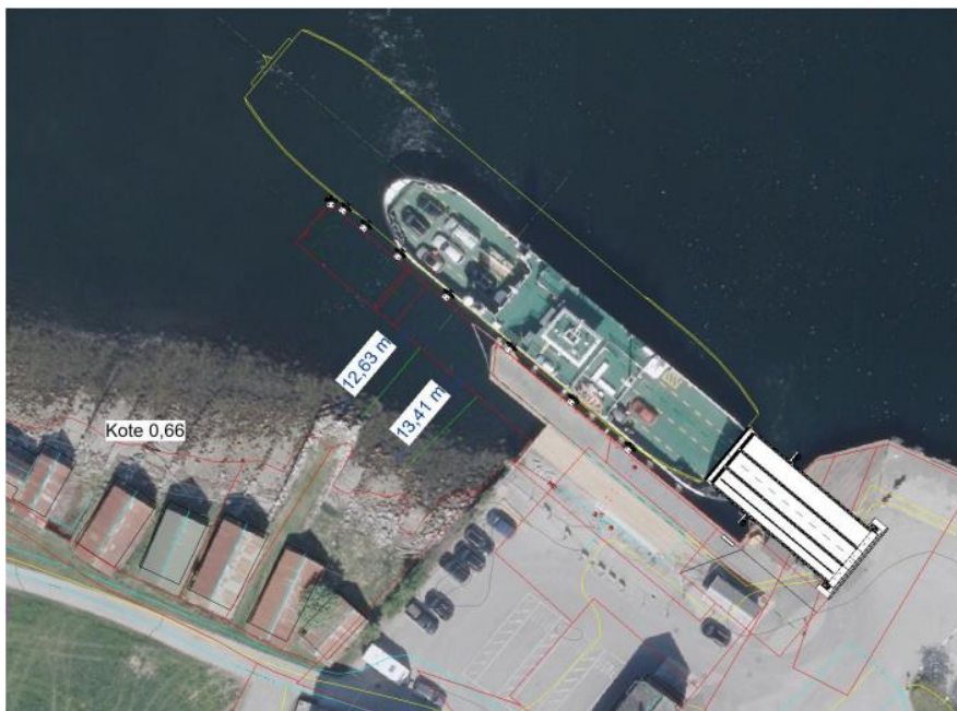
Biletet illustrerer ny ferjestorleik med gul markering og ny kailengde i raud markering
