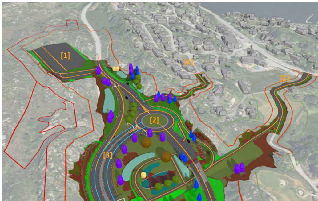
Figur 5.1. [1] Parkeringsplass lengst nordvest i tiltaksområdet. Nordøst i tiltaksområdet, ny rundkjøring [2] og starten på nye Rv. 555 [3]. Sekundærveier til Kolltveitskaret [4] og Stemmebakken [5].
