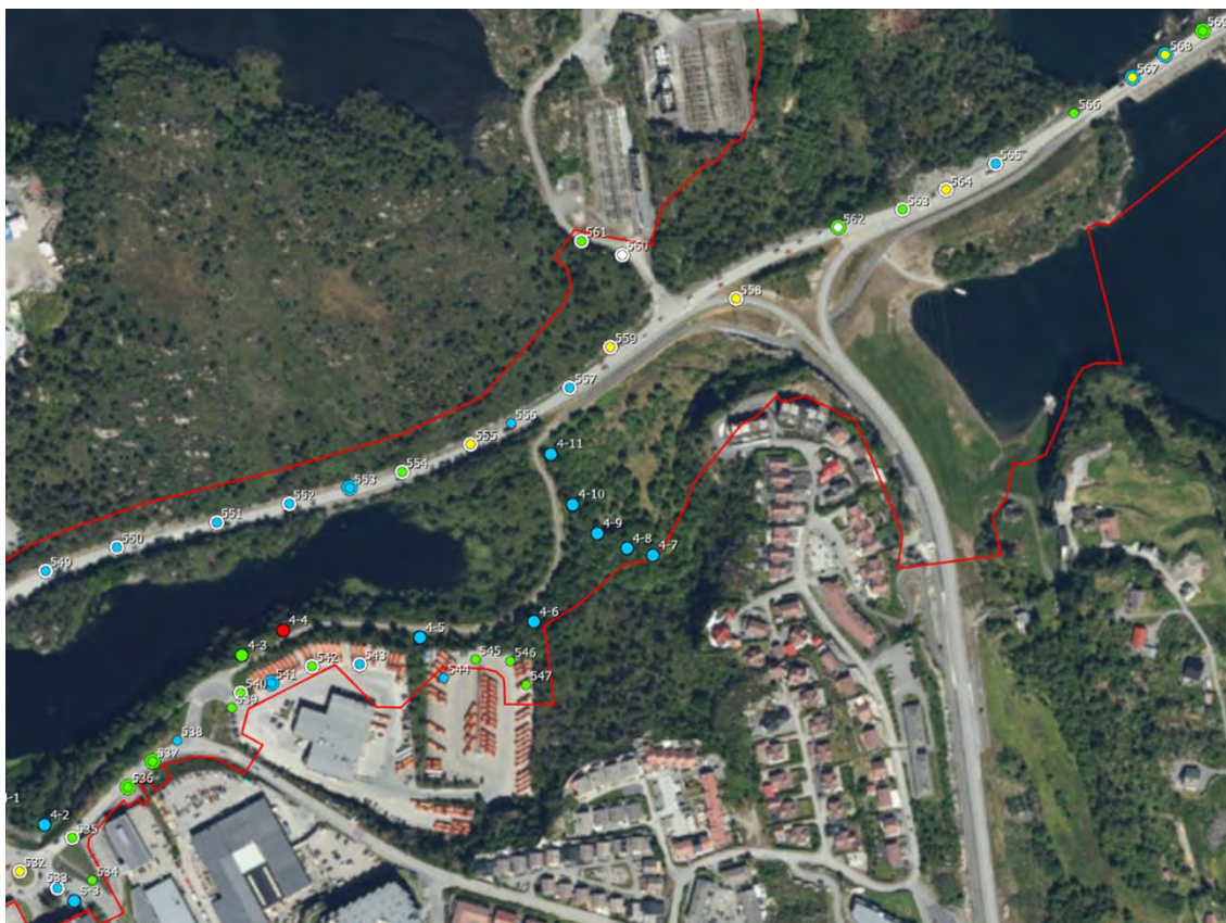
Figur 3.3. Øst for Sartor senter. Fargekoden på prøvepunktene viser høyeste tilstandsklasse (se Figur 3.1) i overflatenære (<1 m, små sirkler) og dypereliggende (>1 m, store sirkler) masser. Hvite sirkler = for grove masser til at prøver kunne tas. Ingen stor sirkel = berg i \geq 1 m dybde (gjelder ikke punktene med nr.: 4-*). Rød linje markerer yttergrensen for tiltaksområdet.
