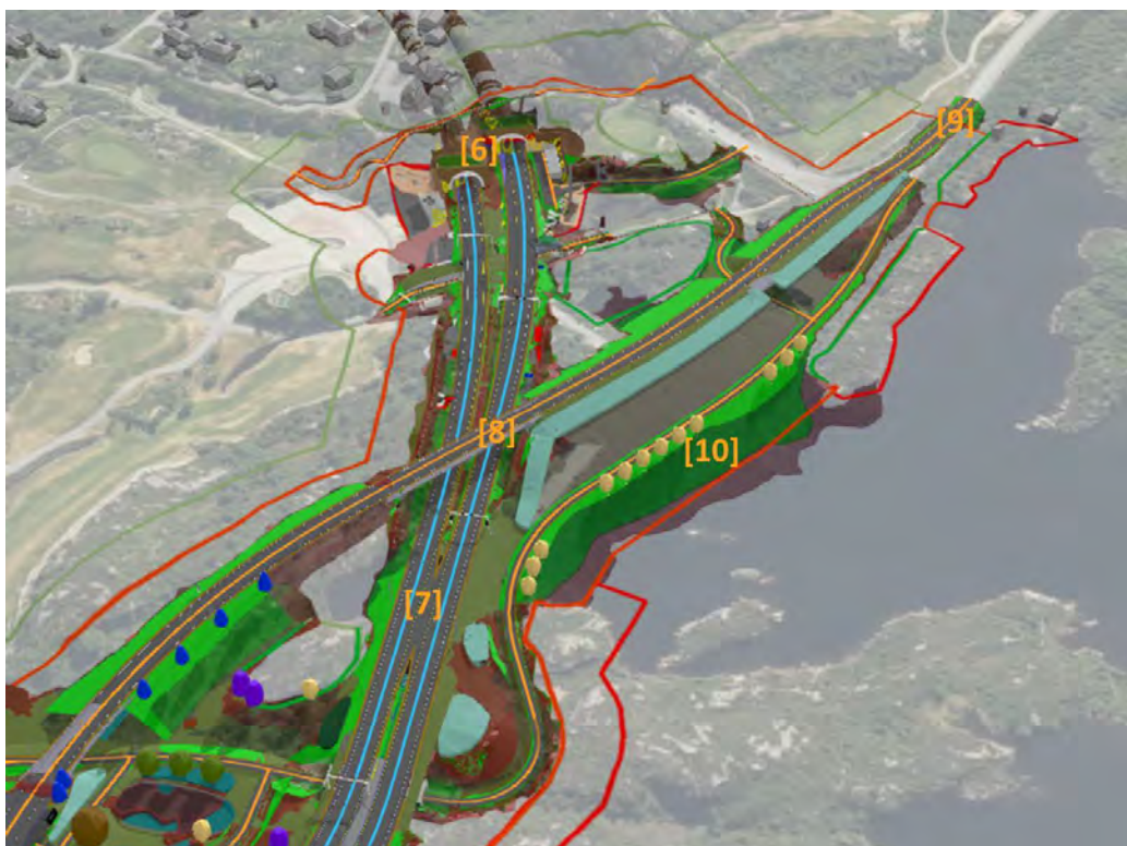
Figur 5.2. Rv. 555 vil krysse eksisterende Skjergardsvegen [7] og gå inn i tunnel ved Kobbeltveit Golf og Naturpark [6]. Nye Skjergardsveien vil krysse i bro [8] over nye Rv. 555 og konvergere med eksisterende Skjergardsvegen [9]. Sekundærvei skal etableres vest for eksisterende Skjergardsvegen og innebærer omfattende utfylling i Storavatnet [10].
