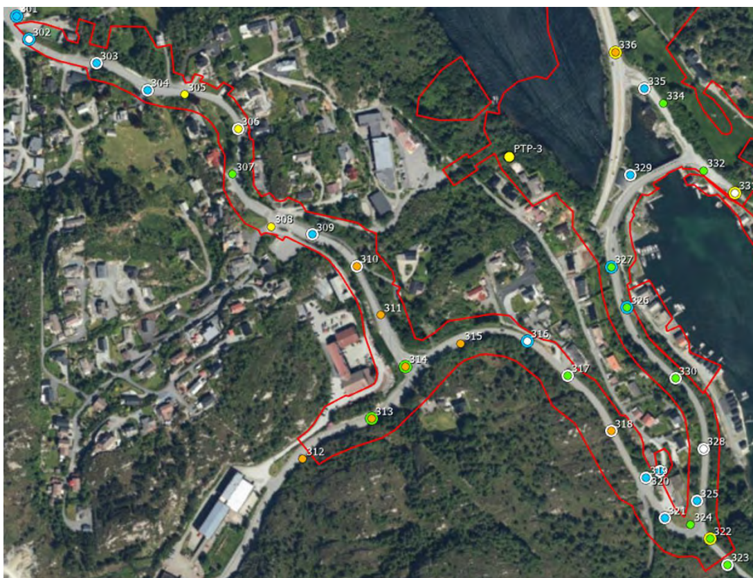
Figur 3.2. Vest for Bildøystraumen. Fargekoden på prøvepunktene viser høyeste tilstandsklasse (se Figur 3.1) i overflatenære (<1 m, små sirkler) og dypereliggende (>1 m, store sirkler) masser. Hvite sirkler = for grove masser til at prøver kunne tas. Ingen stor sirkel = berg i \geq 1 m dybde (gjelder ikke punkt PTP-3). Rød linje markerer yttergrensen for tiltaksområdet.
