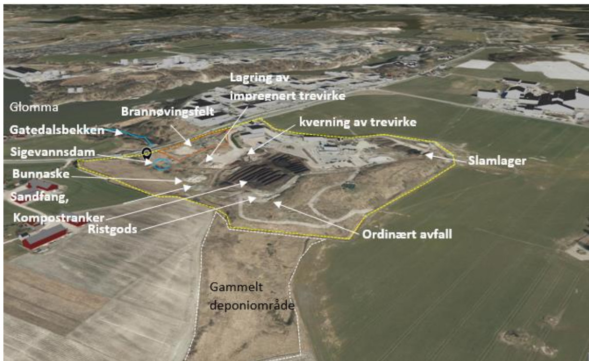
Figur 2. Flyfoto som viser avgrensningen av det aktive deponiet (gul stipt linje) og de viktigste funksjonene i anlegget. Det planlagte brannøvingsfeltet er markert med rød linje. Hvit stipt linje markerer gammelt deponi som ikke lenger er i bruk.
