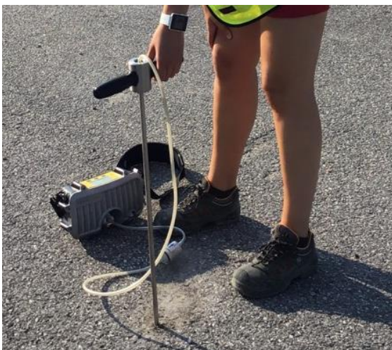
Figur 4 Måling av poreluft med jordspyd.
