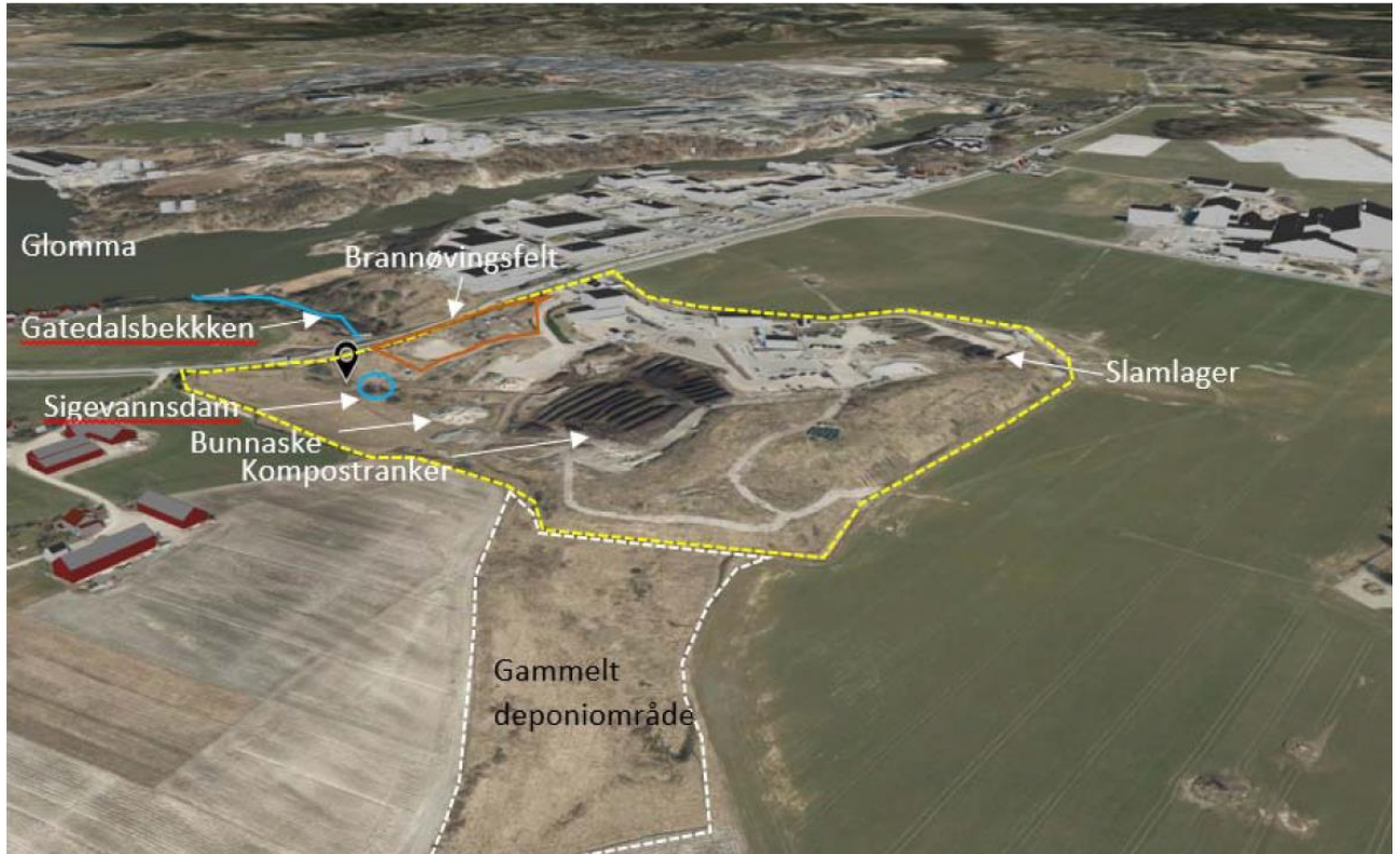
Figur 1 Flyfoto som viser avgrensningen av den delen av deponiet der det pågår aktiviteter per i dag (gul stiple linje) og de viktigste funksjonene i anlegget. Det planlagte brannøvingsfeltet er markert med oransje linje. Hvit linje viser gammelt deponi som ikke lenger er i bruk.
