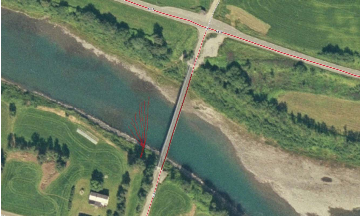
Figur 2. Lokalisering av de åtte kameraene, hvor kablene ut til kameraene er markert med rødt.
