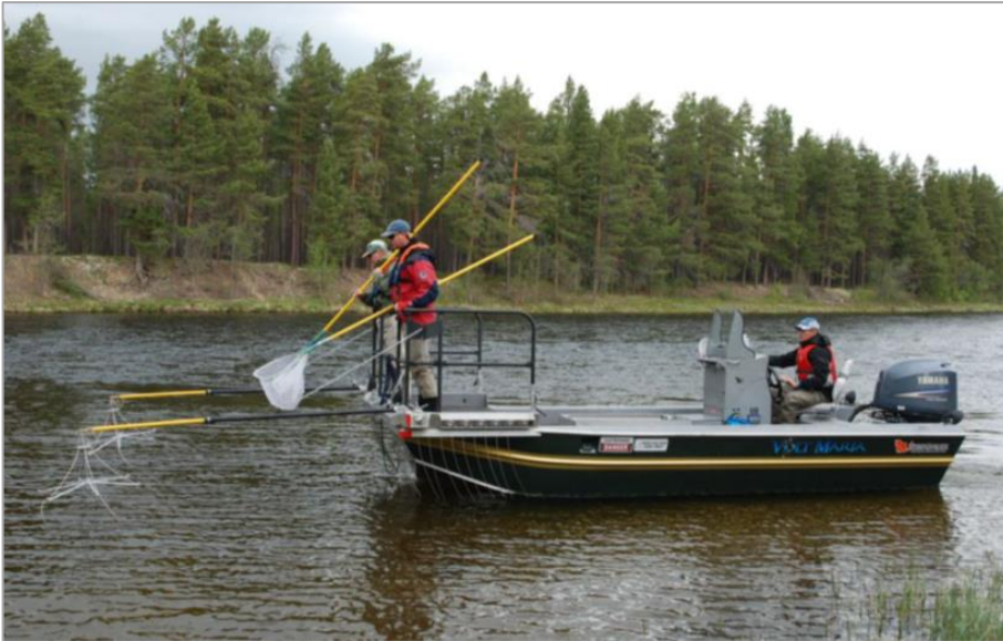
Figur 3. Under det elektriske båtfisket ble det benyttet en 18 fots aluminiumsbåt med en 200 hestekrefters utenbordsmotor med vann-jet. Illustrasjonsbildet er fra en tilsvarende undersøkelse i Rena. Foto: Jon Museth, NINA.
