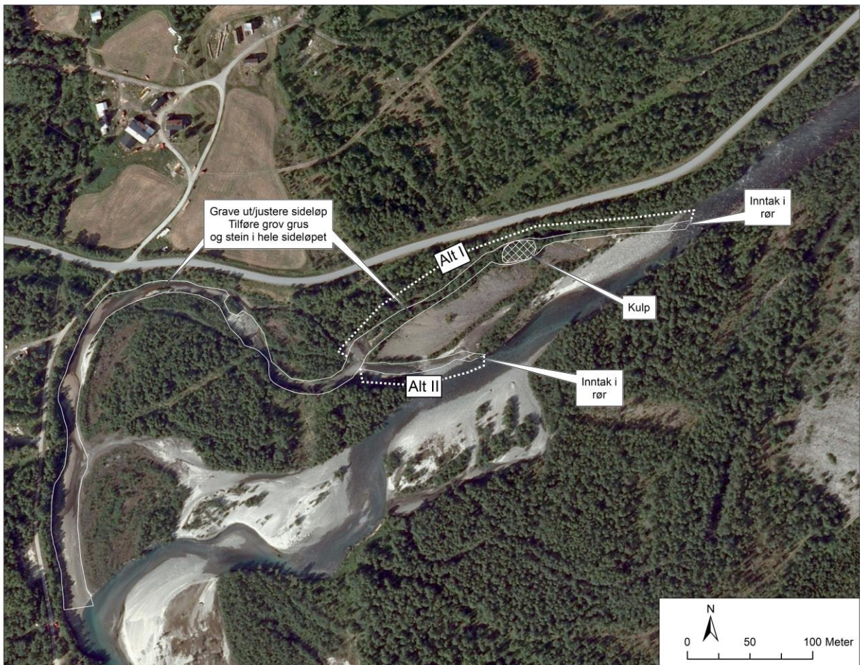
Figur 40. Foto av nedre del av Gjerdalselva med inntegnet forslag til utnyttelse og habitattiltak i sideløp for å øke gyte- og oppvekstområder for sjørørret.
