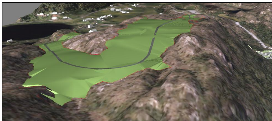
Figur 5-75: Skisse viser stor utfylling i Tangelandsheiane, alternativ med drygt 1 mill. am 3 .
