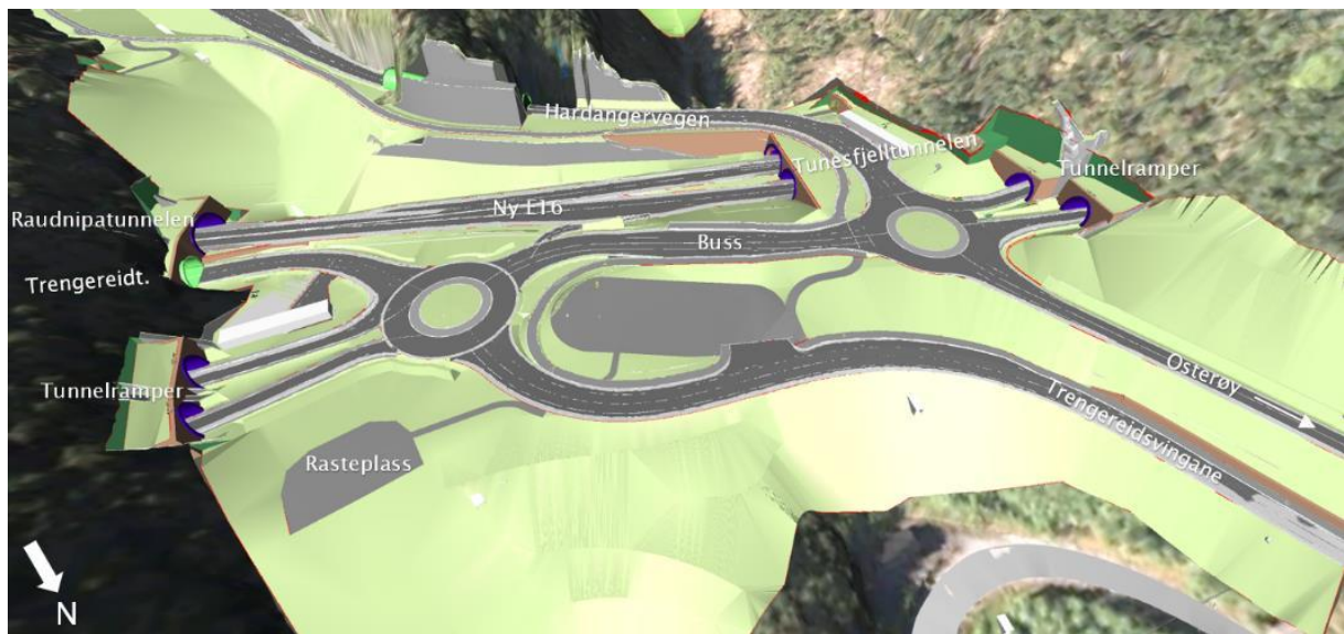
Figur 5-86: Utforming av veg- og baneanlegg og rasteplass ved Trengereid, sett i retning sørøver.
