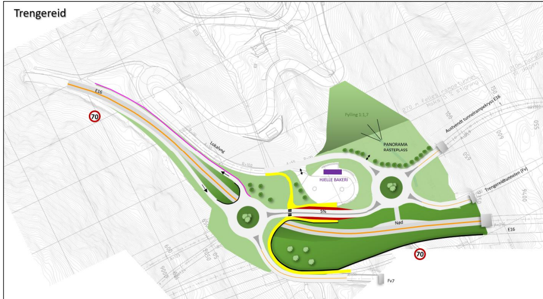
Figur 12-3 Midlertidig kryssløysing med byggetrinn E.
