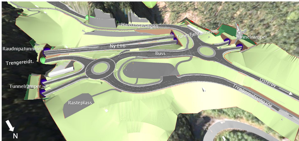
Figur 5-26: Ny situasjon på Trengereid. Omarbeidd kryssområde, med ny E16, nye rundkøyningar, tunnelramper som koplar seg på rundkøyringane, og endra veg ned til Trengereid og nytt rasteplassområde.
