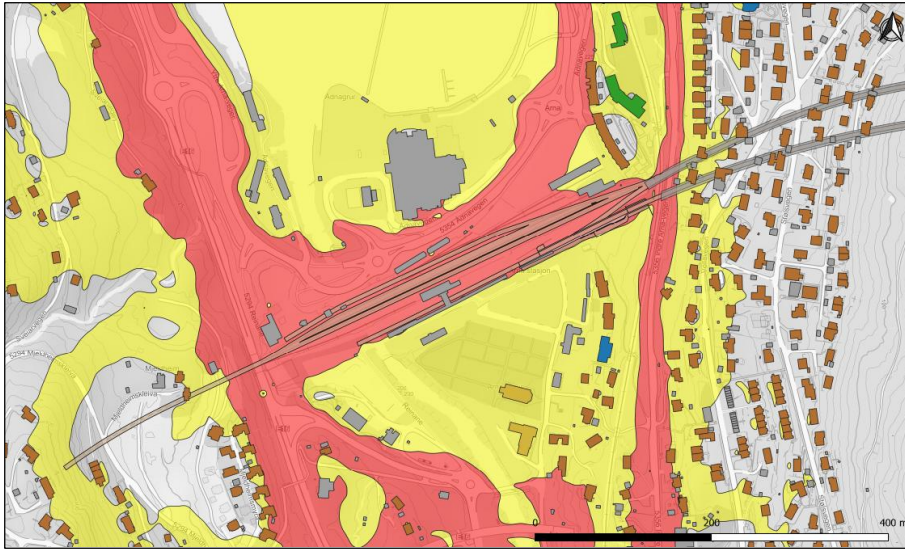
Figur 5-98: Ingen bustader frå merkbar endring i støynivå ved etablering av ny portal og spor på Arna stasjon.
