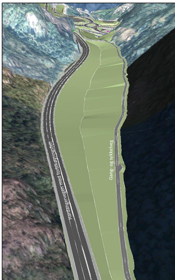
Figur 5-27: Ny situasjon for Hardangervegen, med nytt forbikjøringsfelt opp Trengereiddalen og med samanhengande gang- og sykkelveg mellom Trengereid og Gullbotn. I utklippet til venstre ser ein nedover dalen til vegkrysset E16/Hardangervegen ved Trengereid, og til høgre ser ein frå Gullbotn retning mot Trengereid.
