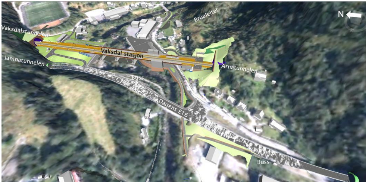
Figur 5-23: Ny situasjon for planforslag B2 på Vaksdal. Ny stasjon på bru over dalen, aust for eksisterande E16.
