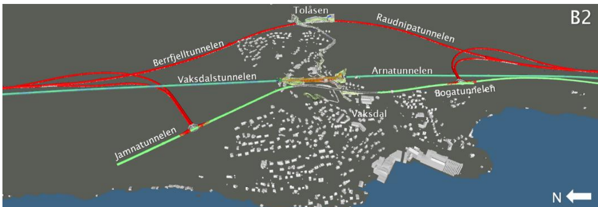
Figur 5-21: Utklipp frå modell for planforslag B2 på Vaksdal. Viser dagsonene og tunnelsystemet, med tunnelrampar til Boga- og Jamnatunnelen.
