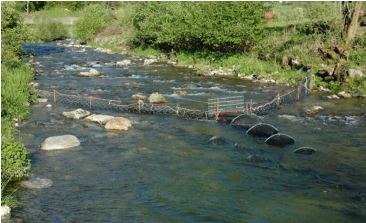
Bilde viser bruk av elveruse for innfangning av laksesmolt i restfeltet i Vikja. Fellen med ledegarn stenger her hele elveprofilen. Foto: LFI, Uni Miljø
